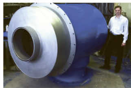
ООО НПП «ТЕСКА», горелка ГСС-3000Р-ИС (30 МВт) на производственном участке, после покраски.
